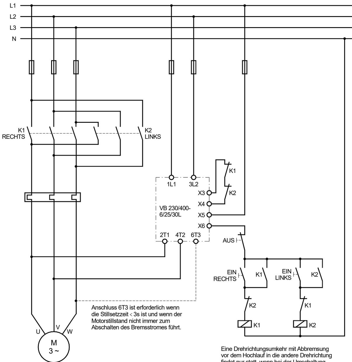
Anschluss 6T3 ist erforderlich wenn die Stillzeit < 3s ist und wenn der Motorstillstand nicht immer zum Abschalten des Bremsstromes führt.
