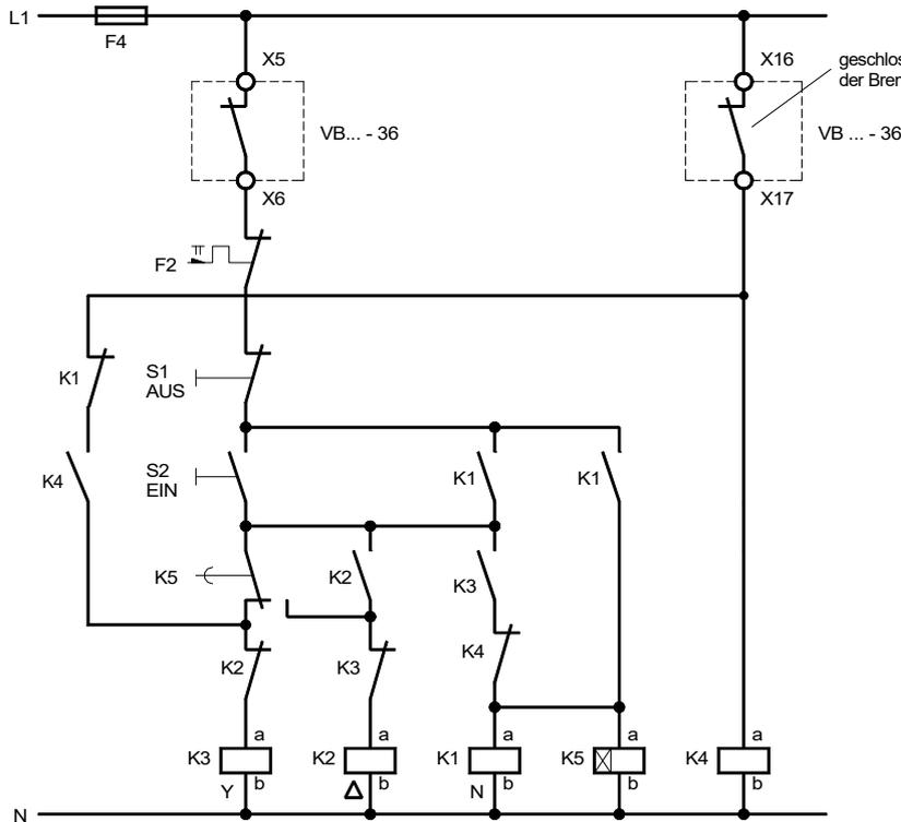
Die Handbetätigung der Schütze ist während des Bremsvorganges verboten, da der mögliche Wischkurzschluß die Leistungshalbleiter zerstört.
