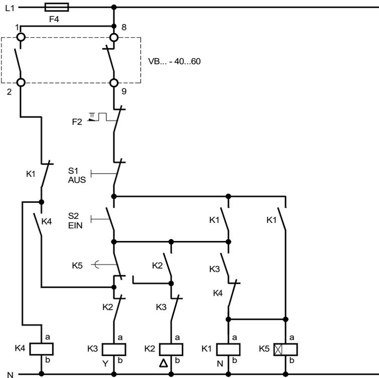
Die Handbetätigung der Schütze ist während des Bremsvorganges verboten, da der mögliche Wischkurzschluß die Leistungshalbleiter zerstört.
