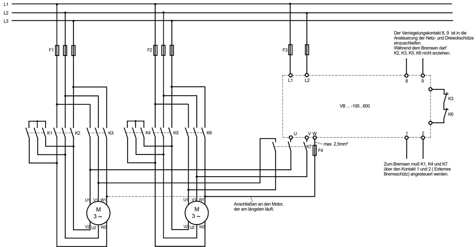
Der Verriegelungskontakt 8, 9 ist in die Ansteuerung der Netz- und Dreieckschütze einzuschleifen. Während dem Bremsen darf K2, K3, K5, K6 nicht anziehen.
