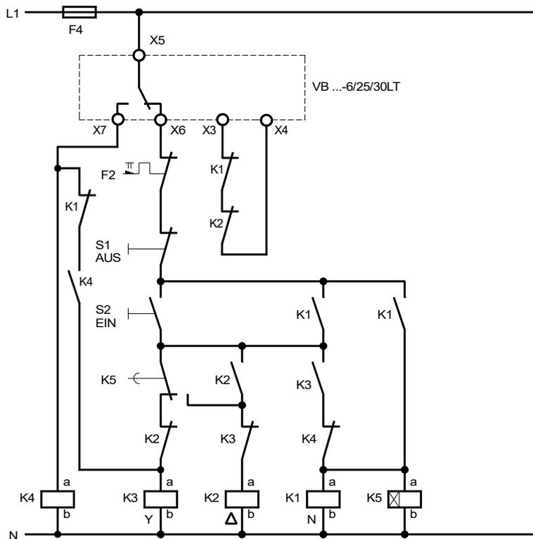
Die Handbetätigung der Schütze ist während des Bremsvorganges verboten, da der mögliche Wirschkurzschluß die Leistungshalbleiter zerstört.
