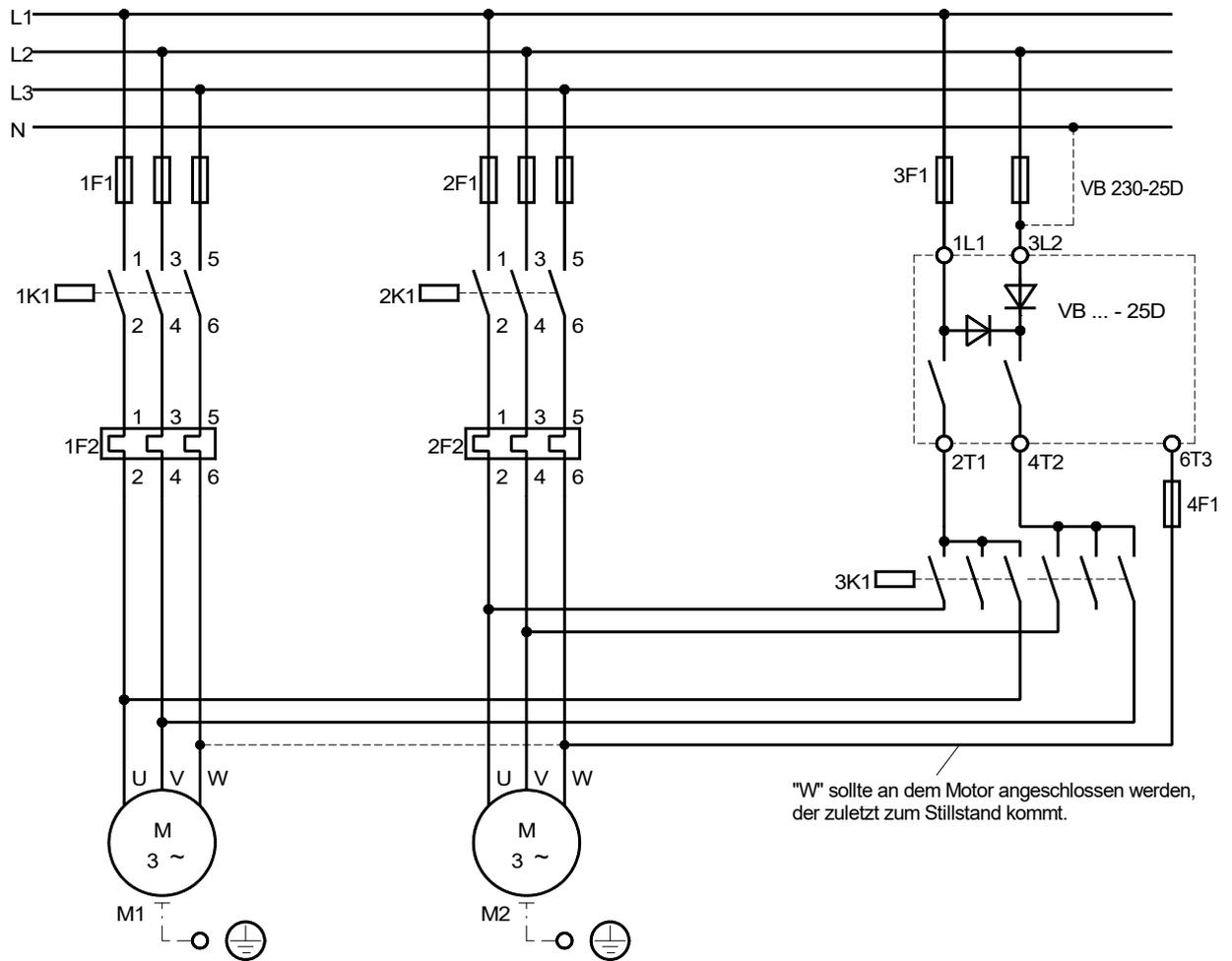
"W" sollte an dem Motor angeschlossen werden, der zuletzt zum Stillstand kommt.
