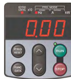
Abb. 5.2 Anzeige des LED-Monitors nach dem Einschalten
